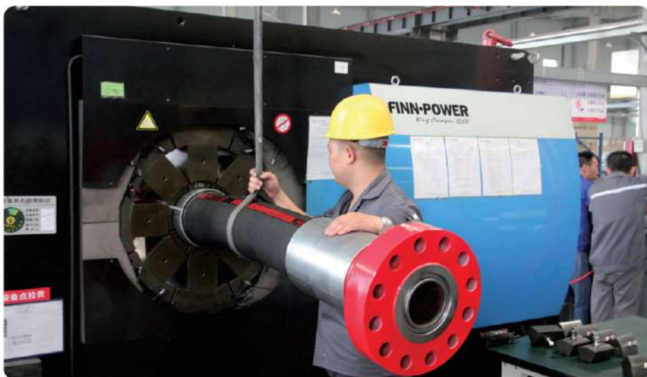
工业软管总成扣压工序 Assembly Process
